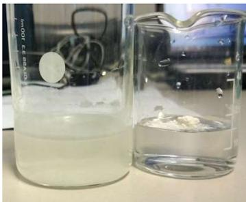
*Darstellung Dispergierbarkeit PEEK-Pulver in H<sub>2</sub>O: plasmabehandeltes PEEK (links), unbehandeltes PEEK (rechts)*
