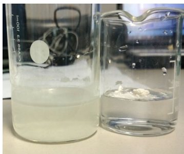
Darstellung Dispergierbarkeit PEEK-Pulver in H 2 O: plasmabehandeltes PEEK (links), unbehandeltes PEEK (rechts)
