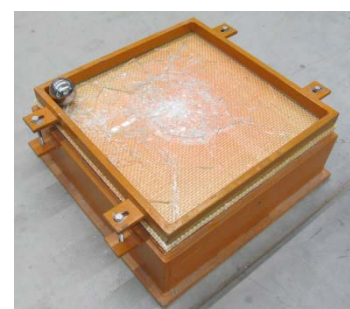
Kugelfalltest an einer Glasscheibe mit Pulverlack und Glasfasergewebe zum Nachweis der Bruchsicherheit
