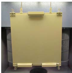
Vertikale Beschichtung von Glasoberflächen mit Pulverlack
