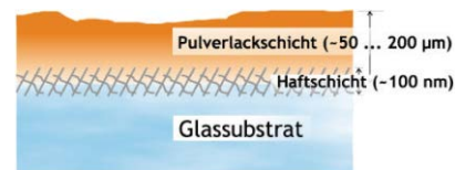
Aufbau der Glas/Pulverlackverbindung unter Verwendung der entwickelten Oberflächenvorbehandlung
