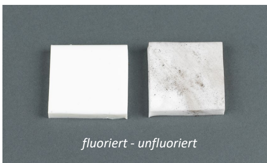
Vergleich der Verschmutzungsneigung von fluorierten und unbehandelten Silikonoberflächen
