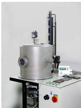
Bedampfungsanlage B30 mit Glimmentladung
