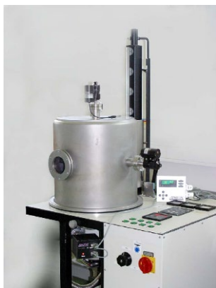
Bedampfungsanlage B30 mit Glimmentladung
