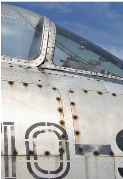
Abbildung 1: Die Vernietung zweier Metalle verursacht eine schädliche Kontaktkorrosion. (INNOVENT e.V.)
