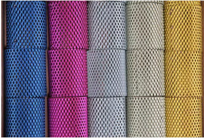
Abbildung: Anodisierte Katalysatoroberflächen auf Titanstreckmetall (INNOVENT e. V.)
