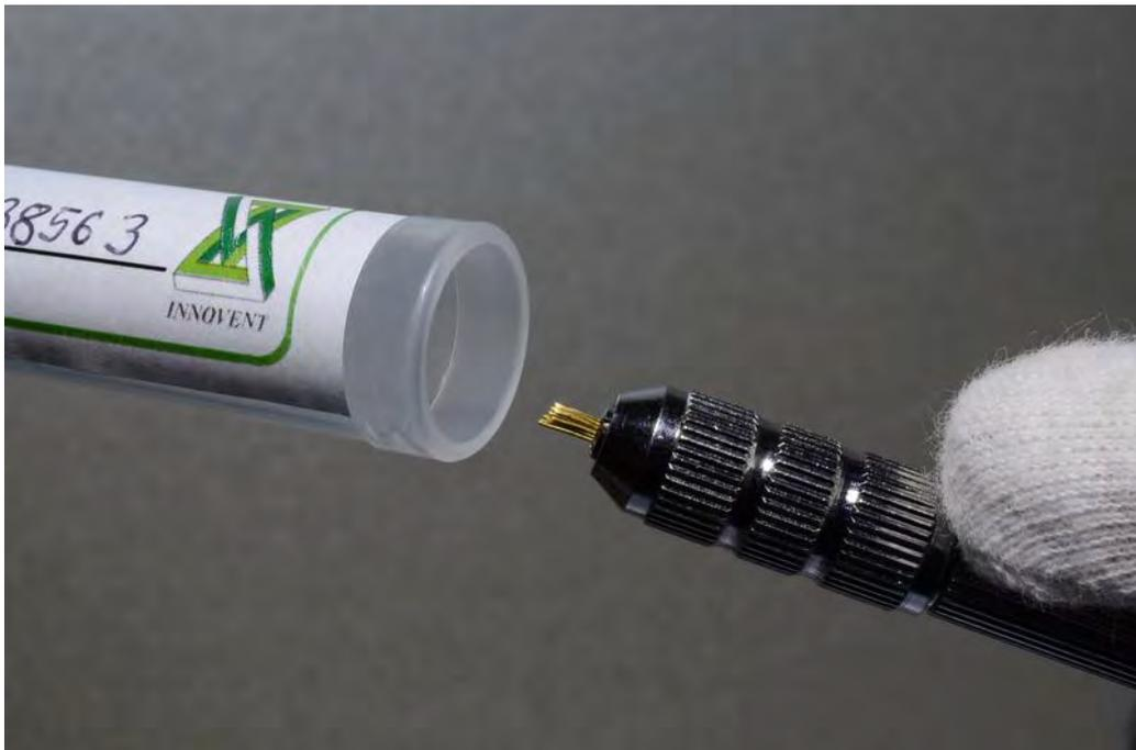
Abbildung 2: Probenentnahme mit dem Technischen Wattestäbchen
