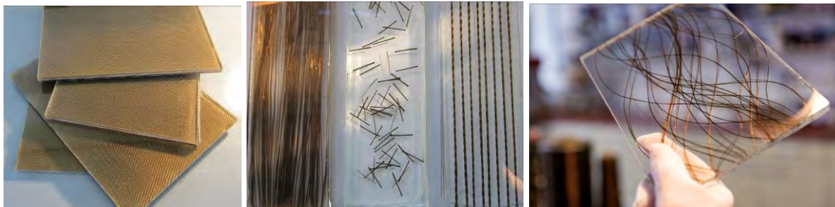
Abbildung 2: Beispiele unterschiedlicher Variationen zur Einbindung von Basalttextilien zwischen Glas
