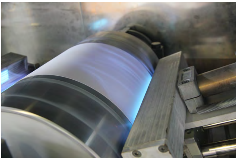
Abbildung 1: Flammenpyrolytische Beschichtung von textiler Bahnware ©INNOVENT e.V.
