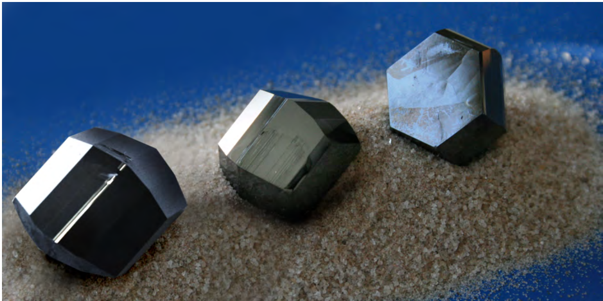
Abbildung: Ferrit-Einkristalle für Hochfrequenz-Filterkomponenten gezüchtet aus Hochtemperaturlösungen (INNOVENT e.V.)
