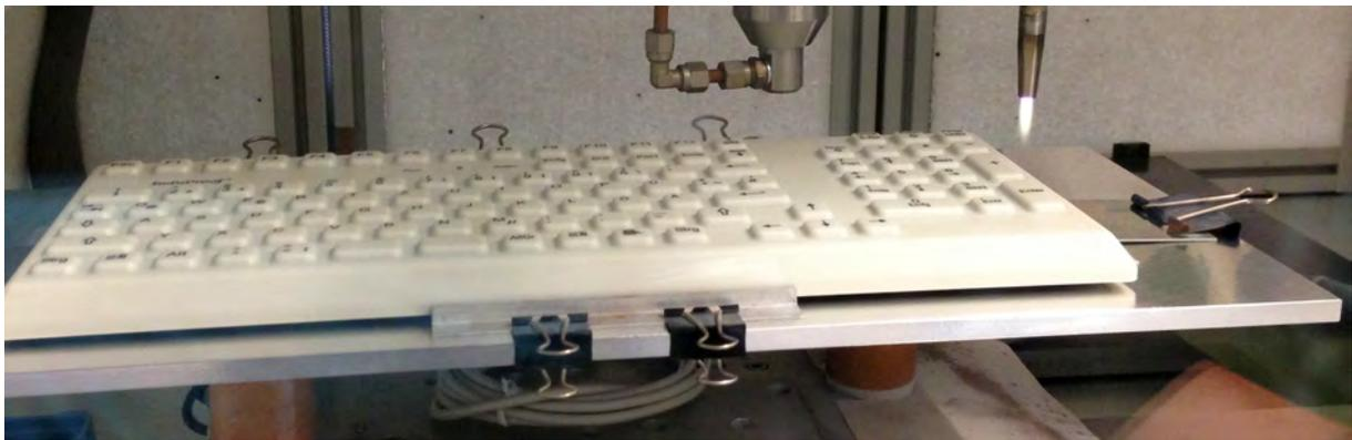
Abbildung 3: Eine Tastatur für den medizinischen Gebrauch, beschichtet mit einer Zinkoxidhaltigen Wirkstoffschicht.
