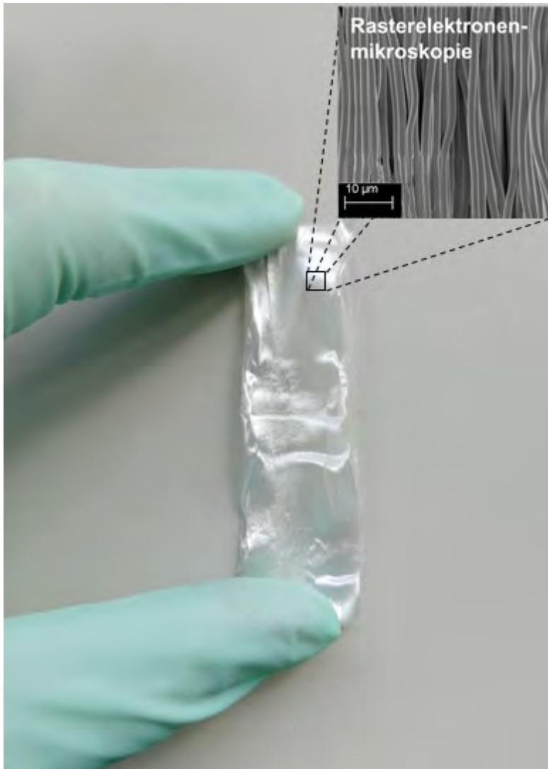
Abb. 1: Elektrogesponnenes Vlies mit gerichteten Polymerfasern
