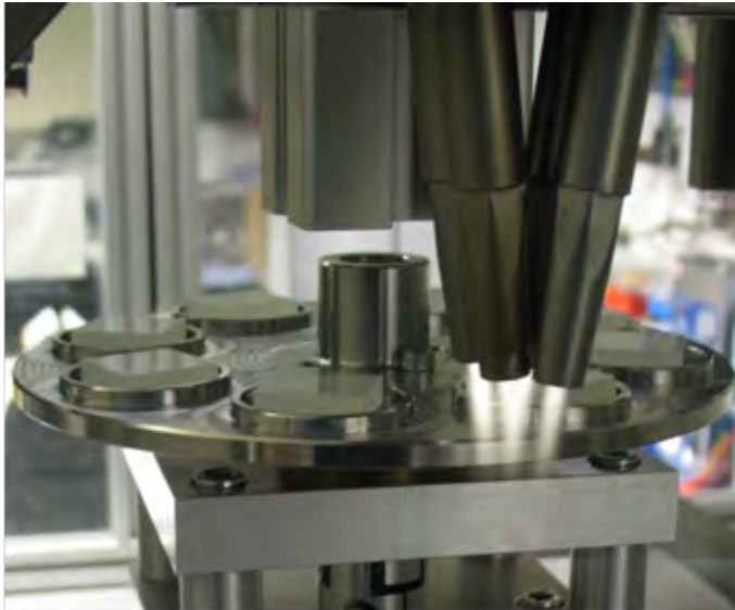
Abbildung: Plasmaunterstützte Vorbehandlung von acht Kunststoff-Prüfkörpern, die auf einem rotierenden Halter befestigt sind (INNOVENT e. V.)
