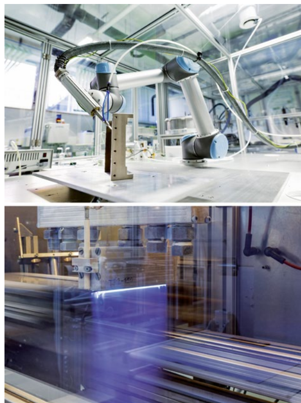
Bild 1 > Beispiele für die Prozessführung einer Atmosphärendruckplasmabehandlung (oben) und einer Flammbehandlung (unten)
