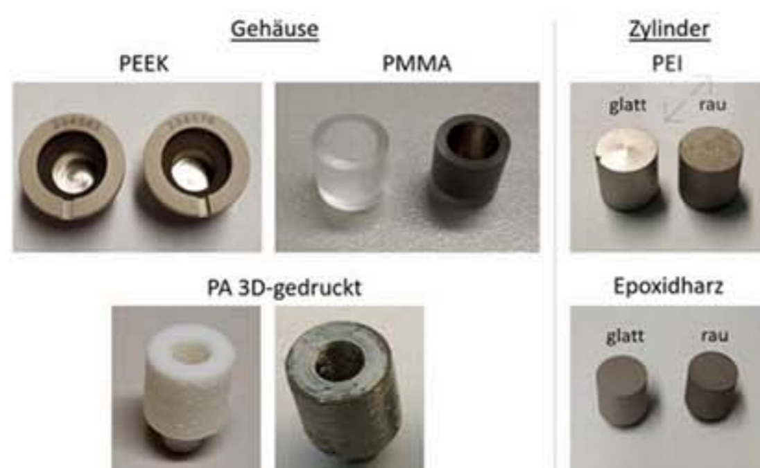
Diverse Ansichten von mit der neuen Metallisierungsmethode beschichteten Außen- und Innenkonturen von 3D-Kunststoffteil-Oberflächen. (Bild: Innovent e.V.)
