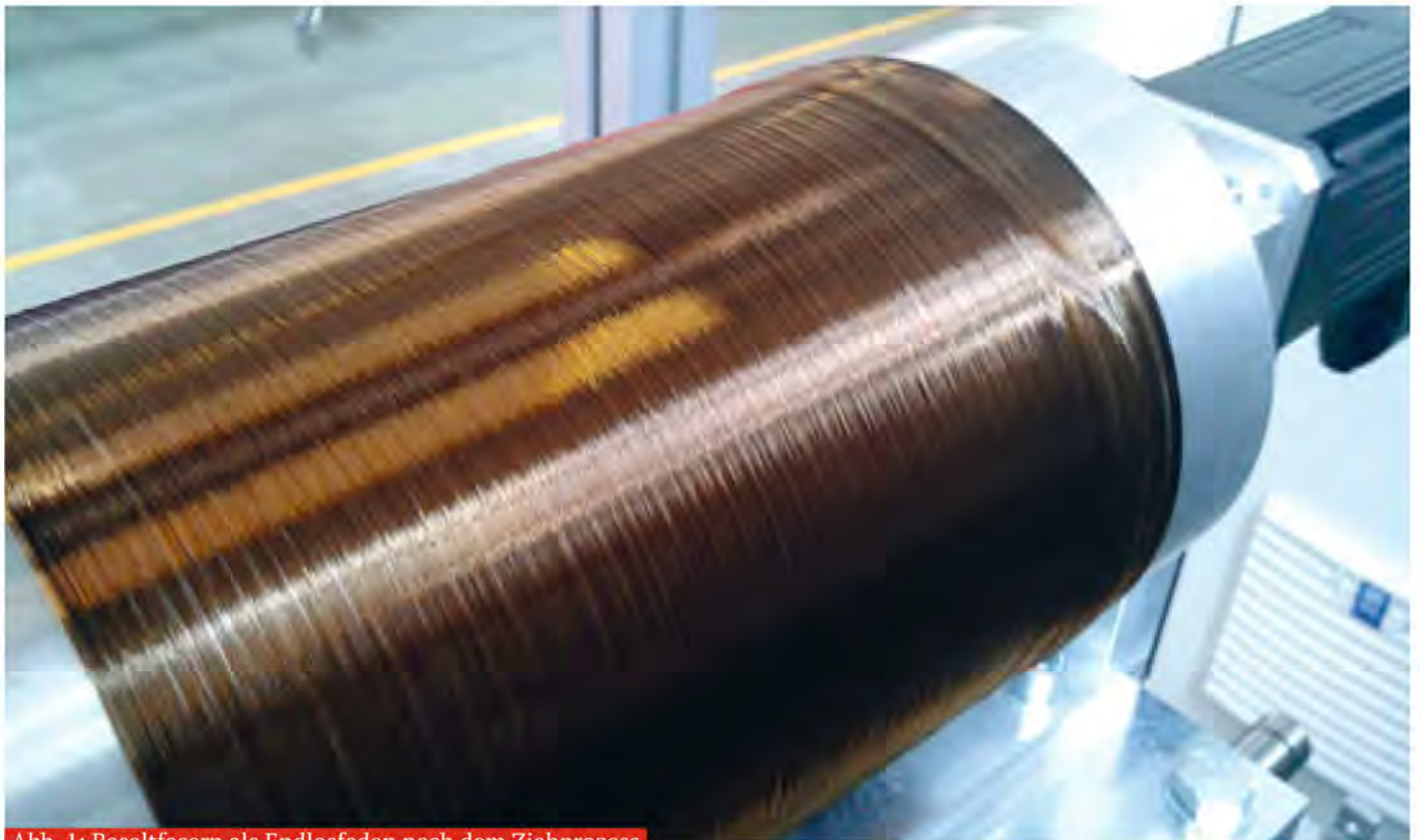
Abb. 1: Basaltfasern als Endlosfaden nach dem Ziehprozess
