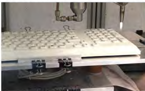
Abbildung 2: Eine Tastatur für den medizinischen Gebrauch, beschichtet mit einer Zinkoxidhaltigen Wirkstoffschicht / Bildquelle: INNOVENT e.V.
