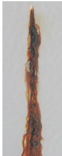
Epoxidbeschichtung 800 h Salzsprühnebeltest (SST)
