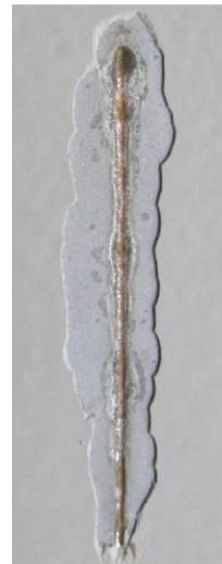
klassische Auswertung → Korrosion, Enthftung
