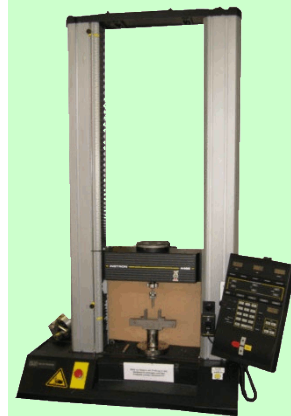
Universalprüfmaschine mit 3-Punkt-Biege-Tool
