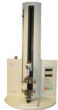
Universalprüfmaschine Shimadzu EZ Test (bis 500 N)
