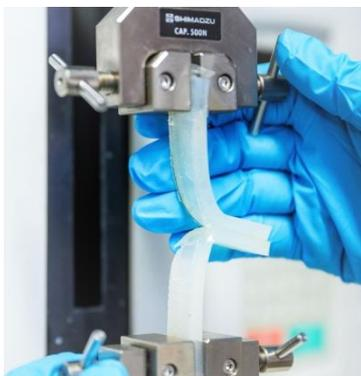
mechanische Spannanzgen an Shimadzu EZ Test
