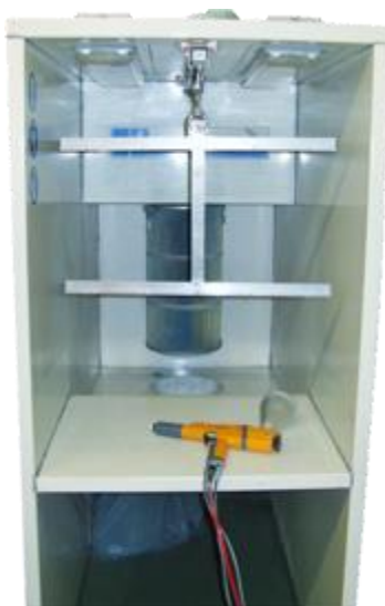
Pulverlackbeschichtungskabine mit Pistole
