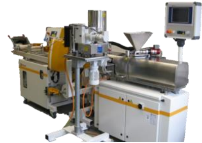
Compounder ZK 16 E x 36D mit ChillRoll zur Folienherstellung
