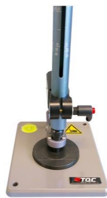
Kugelschlagprüfer: Detailansicht des Auf- pralltisches
