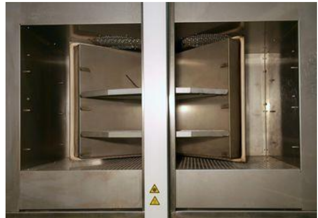
Temperaturschockkammer TSK 200 - geöffnet, Fahrkorb in Mittelstellung
