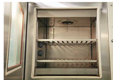
Klimaprüfkammer Feutron KPK 200 Klimaschrank KPK200 - Innenansicht
