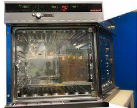
Feuchtekammer HCP 108 mit Moderfäuletest
