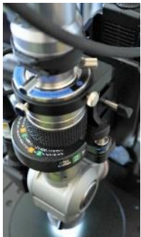
Schwingobjektiv mit 20 - 200 und 200 - 2000-facher Vergrößerung
