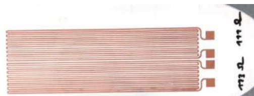
Plasmagespritztes Kupfer als Leiterbahn auf Metallkernleiterplatte
