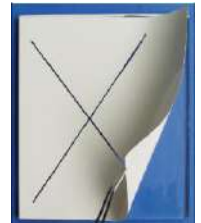
Pulverlackbeschichtete Glasscheiben unter Verwendung der entwickelten Oberflächenaktivierung
