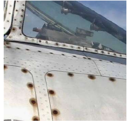
Korrosionsspuren auf einem Luftfahrzeug aus Aluminium
