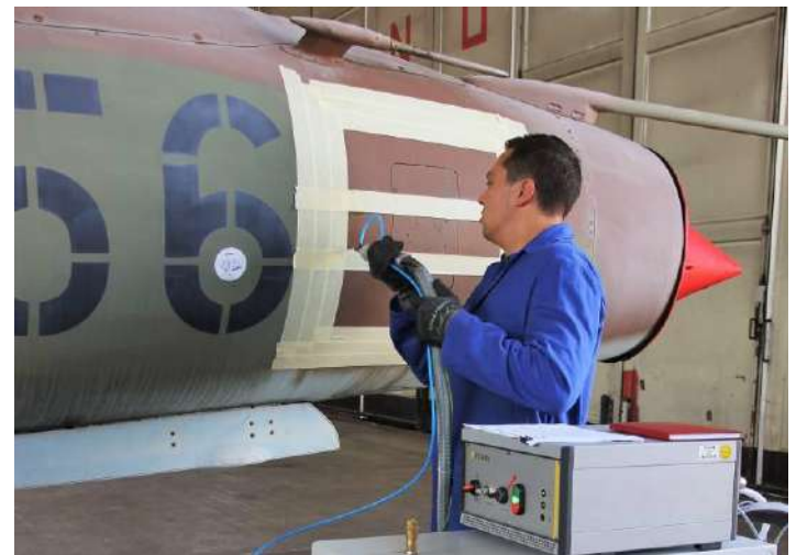
APCVD-Technologie im Einsatz auf Leichtmetall-Testobjekten
