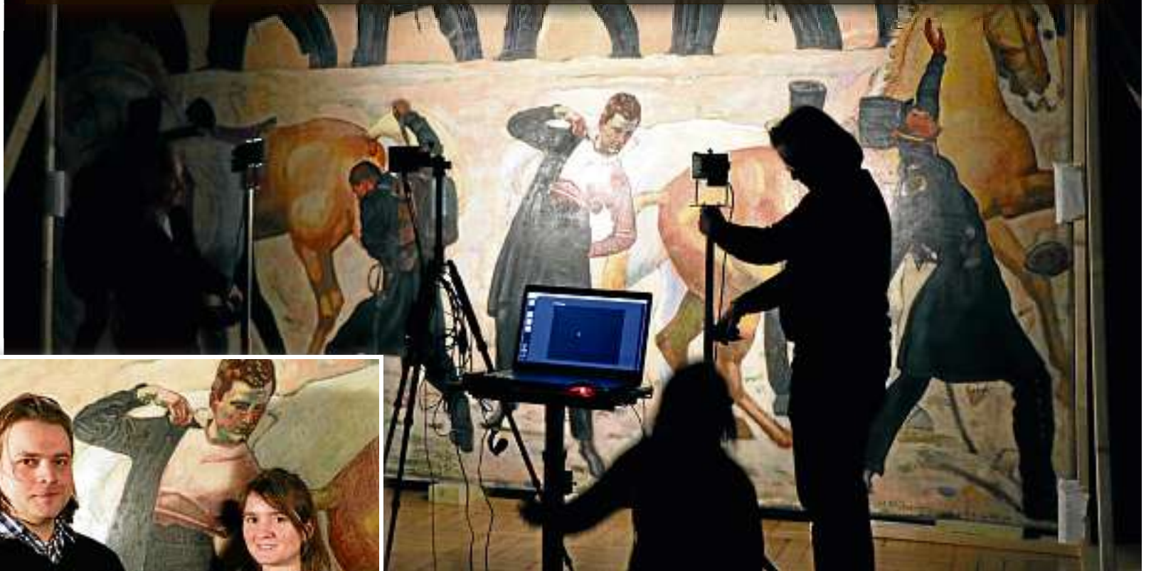
Das Gemälde von Ferdinand Hodler „Auszug der deutschen Studenten in den Freiheitskrieg von 1813“ ist mit einer Hyperspektralkamera untersucht worden. Dafür musste die Aula des Universitätshauptgebäudes dunkel sein und das Licht nur auf den untersuchten Bereich fallen. Kleines Bild: Robert Skoczowsky und Elisabeth Wyrwich von GMBU stellten die Kamera auf. Fotos (3): Katja Dörn
