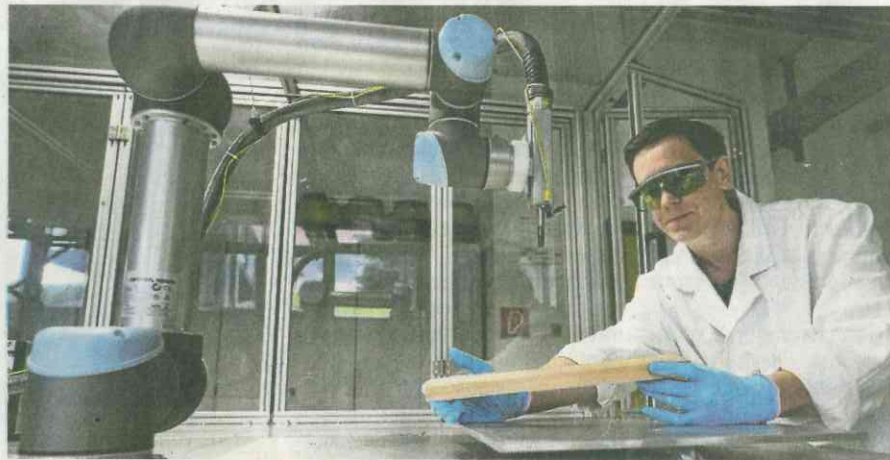
Sven Gerullis testet bei Innovent in Jena die Beschichtung von Lärchenholz mit dem Plasmaverfahren. Foto: Tino Zippel
