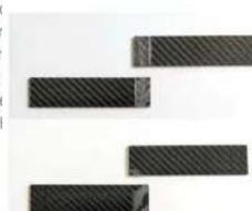
Beispiel für oberflächliche Bruchversagen (Flammbehandlung, Bruch im Klebstoff) und untere adhäsive Bruchversagen (Säure-Behandlung, Bruch in der Grenzfläche Klebstoff/CFK-Bauteil) (Quelle: Innovent)
