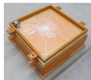
Kugelfalltest an einer Glasscheibe mit Pulverlack und Glasfasergewebe zum Nachweis der Bruchsicherheit
