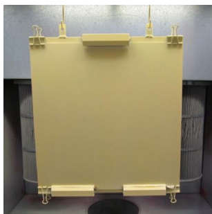
Vertikale Beschichtung von Glasoberflächen mit Pulverlack
