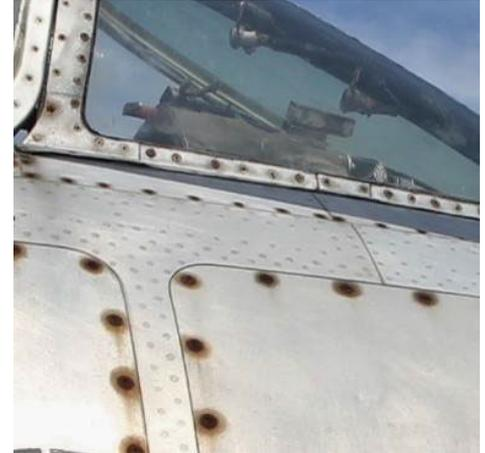
*Korrosionsspuren auf einem Luftfahrzeug aus Aluminium*
