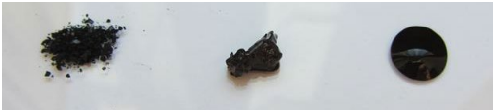
Variable Konsistenz der Nanopartikel-Oleinsäure-Dispersion durch Anpassung der Partikel-Konzentration (links: Pulver mit 90% NP, Mitte: Paste mit 50% NP, rechts: Öl mit 25% NP).
