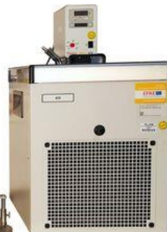
Hot-Disk TPS 2500 S mit verschiedenen Sensoren ab 2 mm Radius und Thermostat für Messungen von -40 °C bis 180 °C
