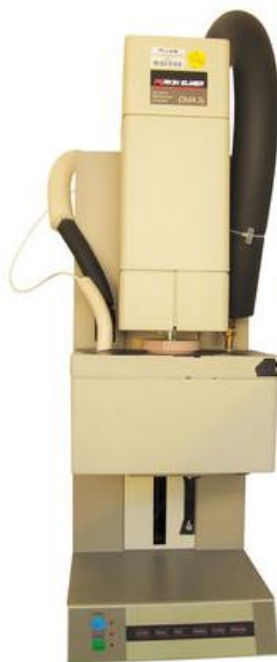
Perkin Elmer DMA 7e (-170 °C bis 1000 °C)
