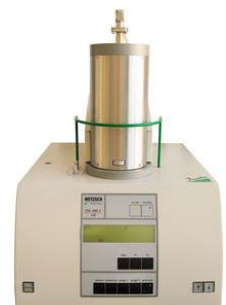
Netzsch STA 449 C (RT bis 1500 °C)
