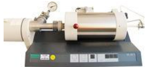
Netzsch DIL 402 C (RT bis 1600 °C)
