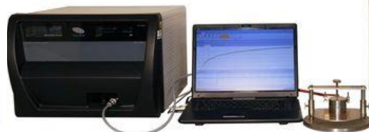
Hot-Disk TPS 2500 S mit verschiedenen Sensoren ab 2 mm Radius und Thermostat für Messungen von -40 °C bis 180 °C
