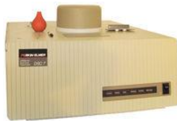
Perkin Elmer DSC 7 (RT bis 500 °C/600 °C)
