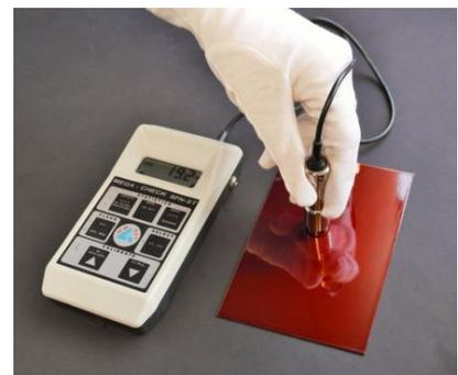
Schichtdickenmessgerät im Einsatz
