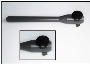
Ritzstichel Typ 436 inklusiver Vergrößerung der Prüfspitze
