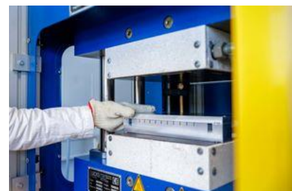
Positionieren eines Presswerkzeuges
