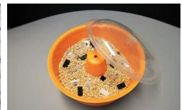
mechanische Belastung von Klebeverbund-Prüfkörpern in Maisschrot
