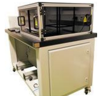
193 nm ArF-Laser (Seitenansicht)
